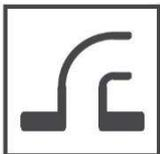
Доступно для исполнений FOX 3F и 2F с отводом для линии удаления воздуха. Конструкция разработана для применения в местах с риском затопления и с целью защиты от попадания загрязнений в основной трубопровод. Другое назначение, защита от эффекта разбрызгивания вследствие быстрого закрытия воздушного клапана. Стандартный материал комплекта SUB выполнен из пластика, по запросу возможно изготовление из других материалов.
